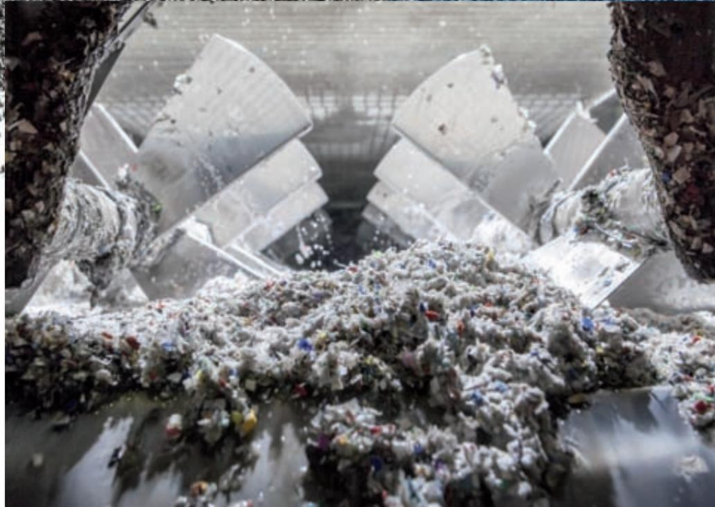
**01** Die sortierten Abfälle werden zunächst trocken zerkleinert, anschließend gründlich gewaschen und getrocknet bevor sie zu Rezyklaten veredelt werden
