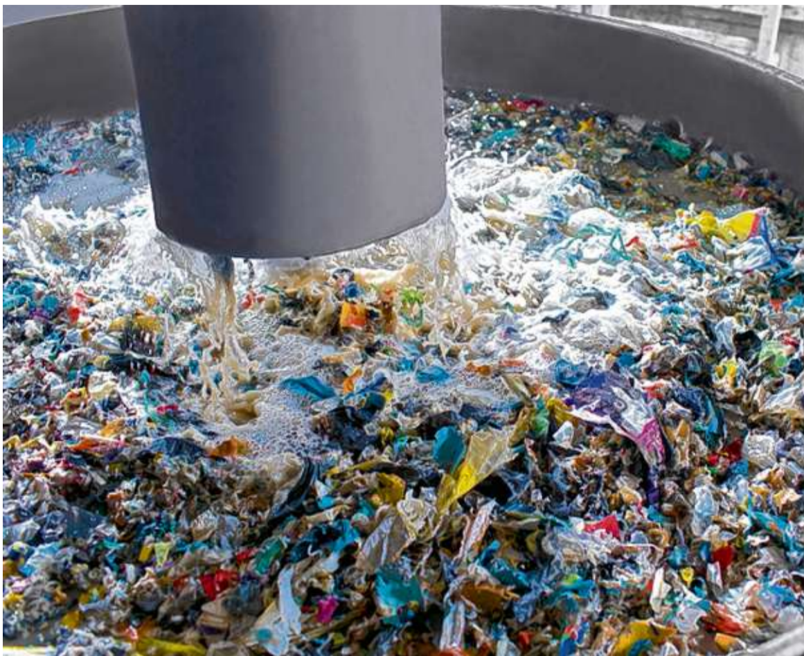
Viele bunte Schnipsel: Eine Maschine wäscht die Flakes und befreit sie von Etiketten. Anschließend werden sie im Extruder geschmolzen.
