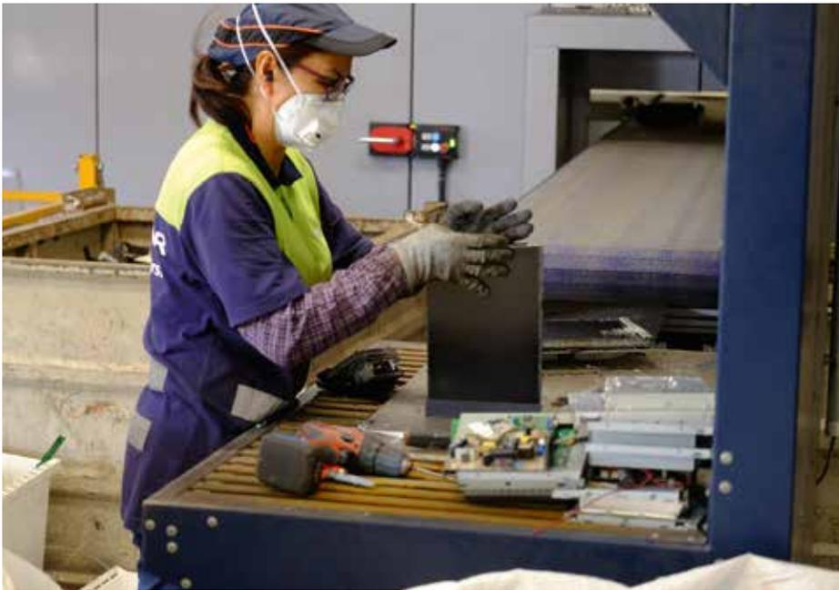
Vor dem Einsatz von Schreddermaschinen werden die Elektro-Altgeräte manuell zerlegt.
