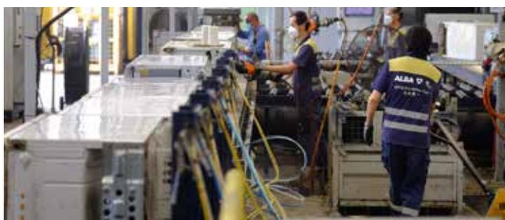
**In den vier Zerlegelinien für Kühlgeräte werden die in den Geräten enthaltenen Kälteflüssigkeiten sorgfältig abgezogen und gesammelt.**
