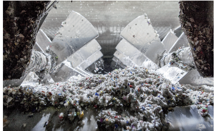
Aus 48.000 t/a Eingangsware ausschließlich aus dem gelben Sack entstehen am Standort in Eisenhüttenstadt jährlich rund 36.000 t PE- und PP-Regrenulate mit definierter Spezifikation.
