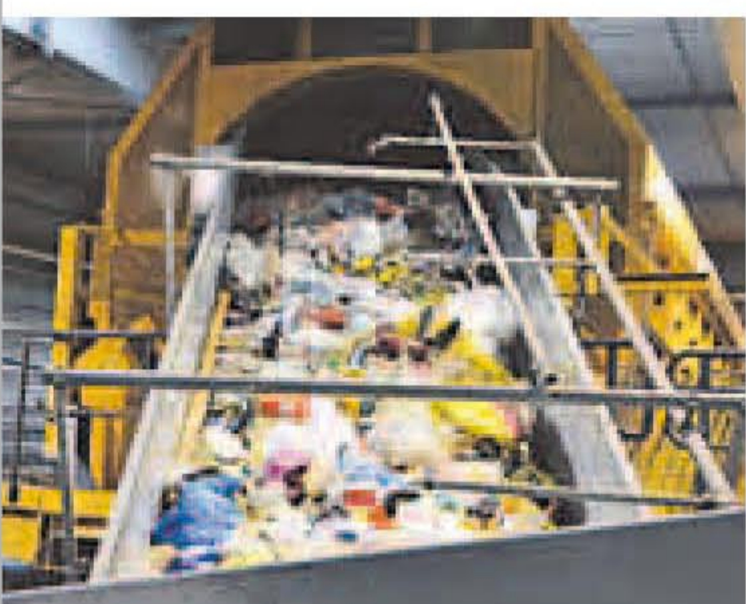
3 In der Sortieranlage wird der Abfall automatisch nach den verschiedenen Plastikarten getrennt
