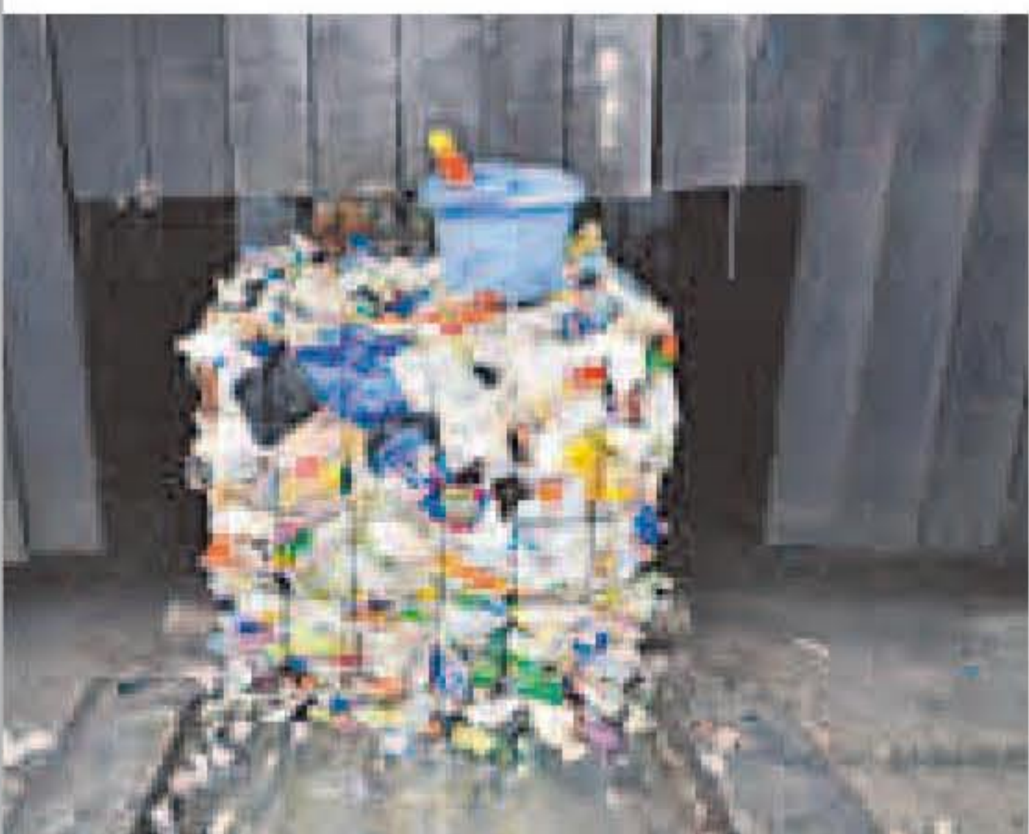
6 Am Ende werden die Plastikarten getrennt voneinander zu Paketen zusammengespreßt. Auf diesem Bild Polypropylen (PP), härteres Plastik
